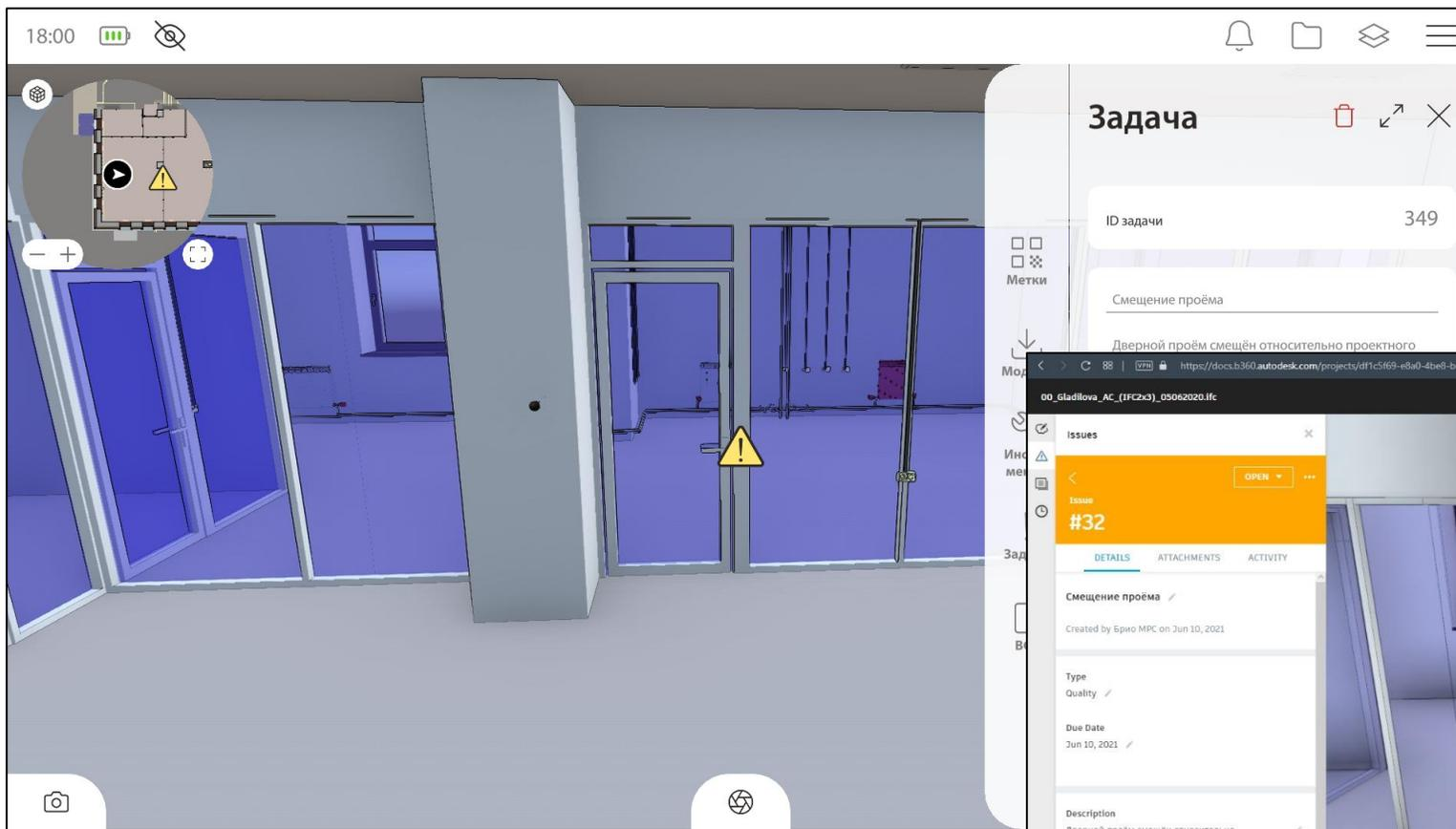
Зафиксированные **отклонения** синхронизируются с BIM360 в виде issues, которые **привязываются к элементу модели и координатам в модели.** **Ракурс** создания замечания, так же **передаётся в СОД**
